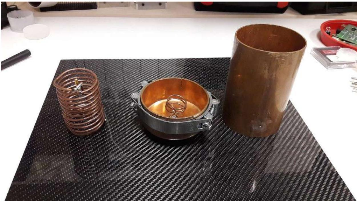
Рис. 7: Резонансный трансформатор для ловушки Пауля в разобранном виде. Для фиксации крышки с антенной использовался силовой хомут. Антенна намотана из медной проволоки диаметром 2 мм и имеет два витка.
