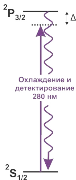
Рисунок 3.5 — Схема лазерного охлаждения ионов ^{24}\text{Mg}^+ . \Delta — красная отстройка частоты лазера от перехода.
