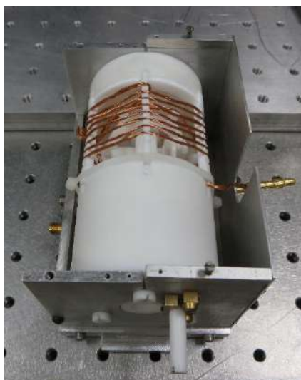
Рис. 17 Фотография резонансного трансформатора из лицендрата на фторопластовой основе.
