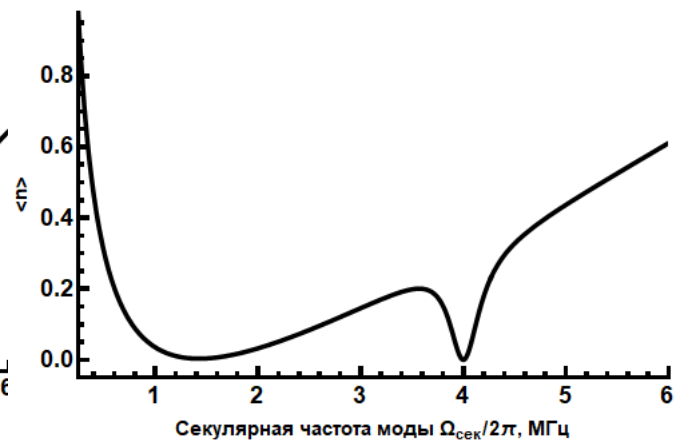
Рис. 39. Зависимость среднего колебательного числа от секулярной частоты моды колебаний. \Omega_{\sigma^-} = 0,5 Г, \Omega_{\sigma^+} = 25 Г, \Omega_{\pi} = 15 Г; \Delta_{\sigma^+} = 2\pi \times 1 МГц, \Delta_{\sigma^-} = 2\pi \times 5 МГц, \Delta_{\pi} = 2\pi \times 1 МГц.
